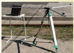
Функциональное назначение: автоматизированный сбор, обработка, хранение, передача и визуализация информации о пространственном положении и ориентации различных объектов.
